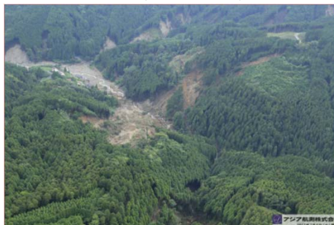
花崗岩と片岩の断層境界での規模の大きい崩壊(空から見る)
